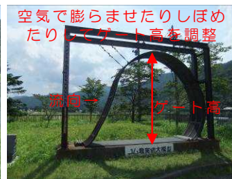
さみだれ大堰とゴム堰の断面模型
